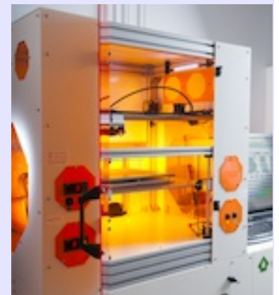
Une bio-imprimante. © LabSkin C.
